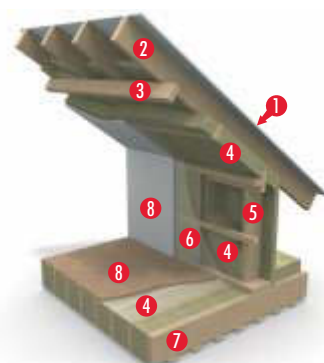
УТЕПЛЕНИЕ МАНСАРДЫ. 1 - кровельное покрытие, 2 - стропильная нога, 3 - обрешетка, 4 - PAROC eXtra, 5 - деревянный каркас, 6 - пароизоляция, 7 - балка перекрытия, 8 - отделка.
