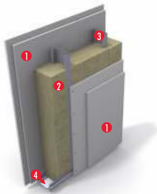
УТЕПЛЕНИЕ МЕТАЛЛИЧЕСКОЙ КАРКАСНОЙ ПЕРЕГОРОДКИ. 1 - 2 слоя гипсокартона, 2 - PAROC eXtra, 3 - металлический каркас, 4 - цокольная планка.
